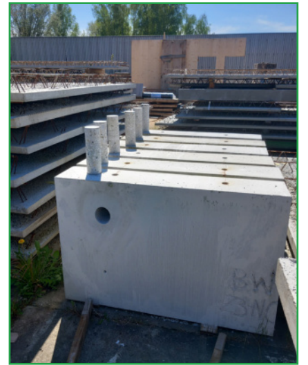
Bilder M&L: Bohrkern aus den mit MetatonZu hergestellten Betonplatten nach einem Jahr freier Bewitterung auf dem Hof
