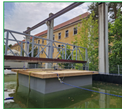
Bilder BTU-Cottbus: Betonponton mit Holzdeckel in der Versuchsrinne BTU-Cottbus und Betonponton mit Styroporkern in Vietnam
